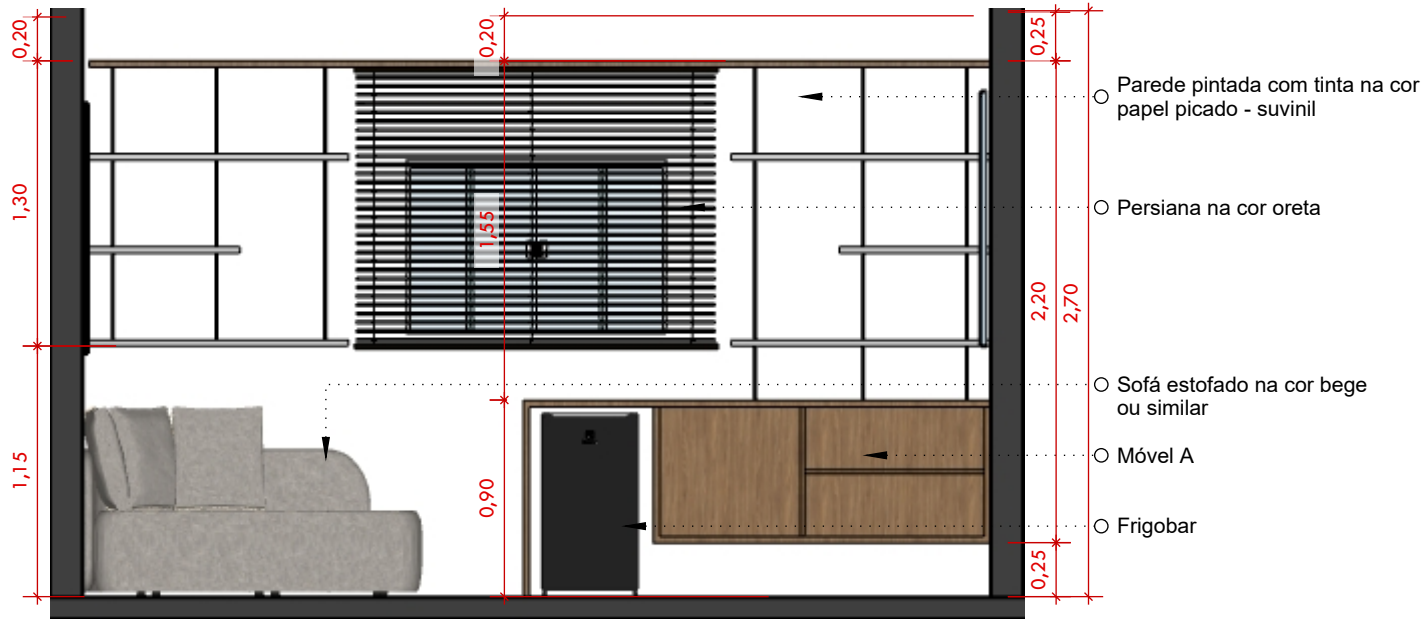
64 CORTE AA - SALA 05 Escala: 1/30
